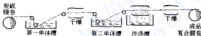
图 6-35 复合膜连续制备工艺示意图
