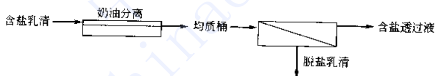
图 8-16 含盐乳清的纳滤处理流程
