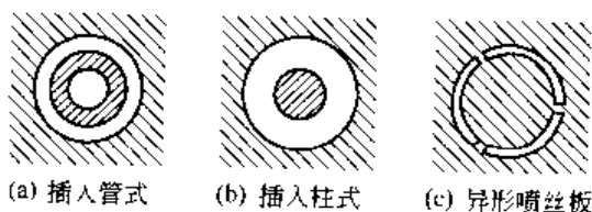
图 6-39 几种常用中空纤维喷丝头断面图
